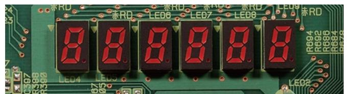
Die einfachste und direkteste Form der Überwachung Ihres Klimasystems ist die 7-Segmentanzeige am Außengerät: Viele Betriebsdaten können hier ohne zusätzliche Hardware abgelesen werden.
