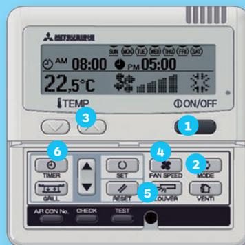
Kabelfernbedienung RC-E5 mit großflächigem LC-Display und integriertem Timer sowie vielen weiteren Zusatz- und Servicefunktionen.
